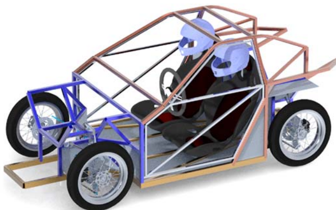
2. ábra - A jármű alumínium vázszerkezete
